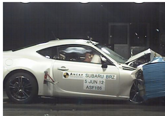
Frontal offset test at 64 km/h (Subaru BRZ)
