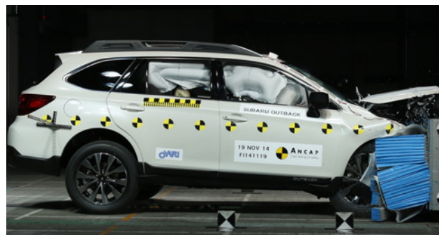
Frontal offset test at 64 km/h (Subaru Outback tested)
